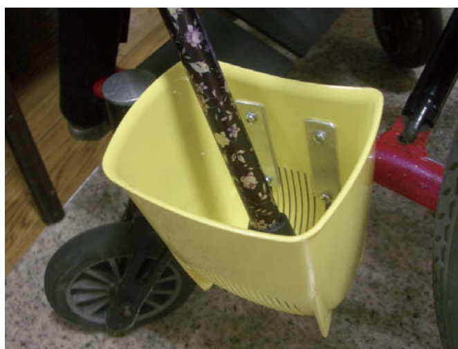
杖立て取付け後の状況
