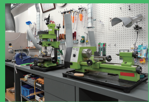
卓上旋盤／卓上フライス盤 金属、樹脂、木材等を切削加工する工作機械です。
